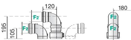
Ø80/80: hasta 57m (24kW) - 52m (28kW)
